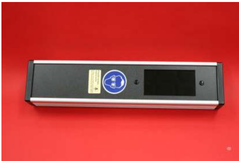
Zdj. nr 32 Lampa dająca światło UV dwuzakresowa – 254 i 366 nm
