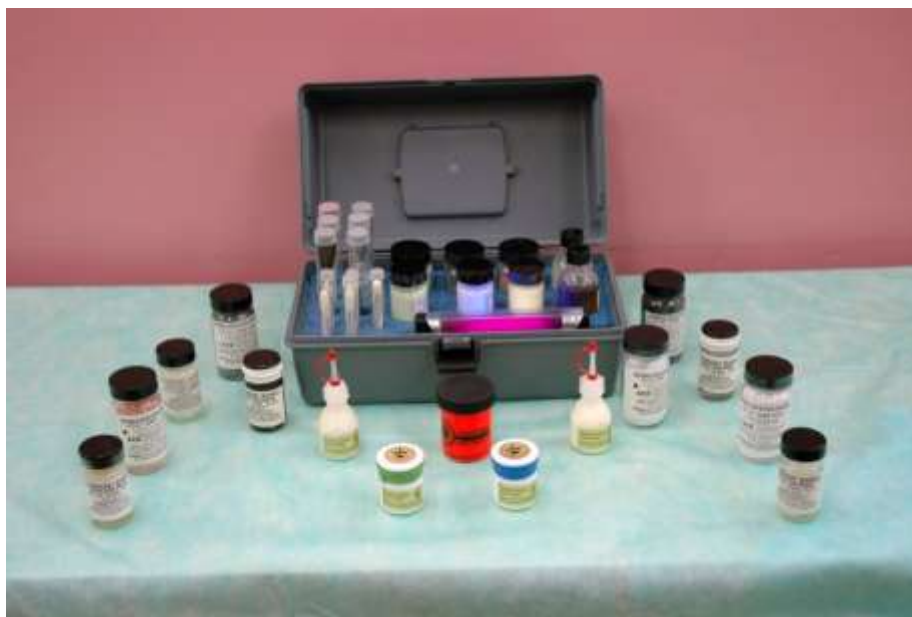
Zdj. nr 12 Podstawowa walizka oraz pojedyncze środki do zakładania chemicznych pułapek znakujących o detekcji widocznej w świetle ultrafioletowym
