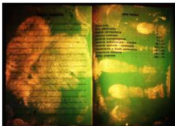
Fot. nr 4. Dokument z ujawnionymi śladami linii papilarnych, po zastosowaniu roztworu DFO, światło 505nm, filtr pomarańczowy
