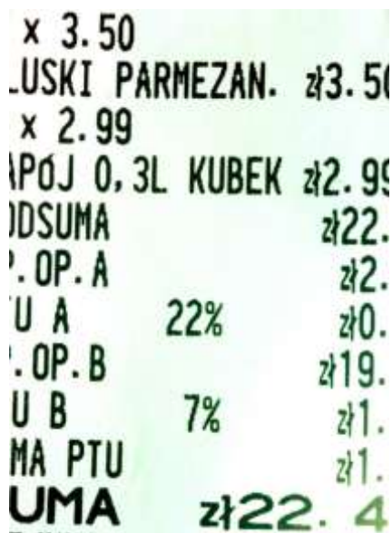
Fot. nr 14. Fragment paragonu z kasy fiskalnej po zastosowaniu roztworu DMAC, światło dzienne
