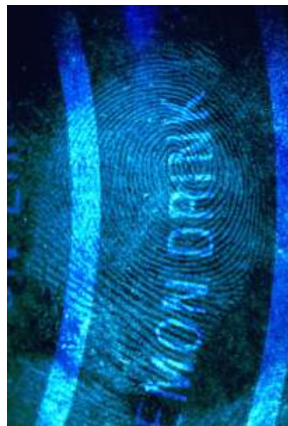
Fot. nr 20. Ślad linii papilarnych ujawniony na powierzchni puszki po napoju „Sparkling Lemon Drink” po zastosowaniu zawiesiny SPR UV, światło UV
