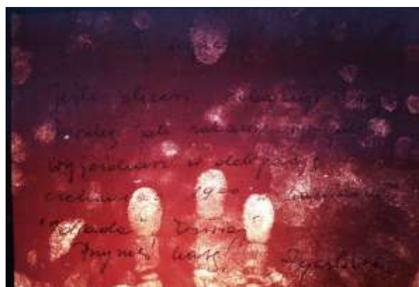
Fot. nr 6. Anonim z ujawnionymi śladami linii papilarnych, po zastosowaniu roztworu 1,2-Indanadione, światło 505nm, filtr pomarańczowy
