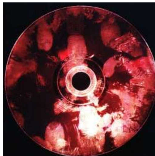
Fot. nr 13. Płyta CD z ujawnionymi śladami linii papilarnych po zastosowaniu roztworu safraniny 0, światło 505nm, filtr pomarańczowy
