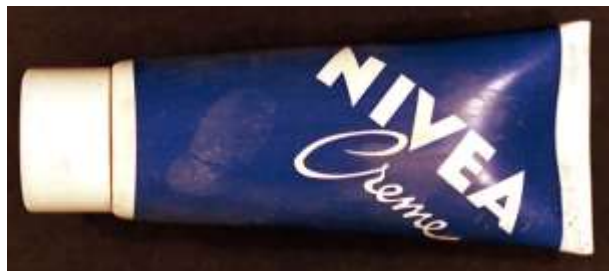
Fot. nr 21. Tuba z kremem Nivea z ujawnionym tłustym śladem linii papilarnych po zastosowaniu zawiesiny SPR białego, światło dzienne
