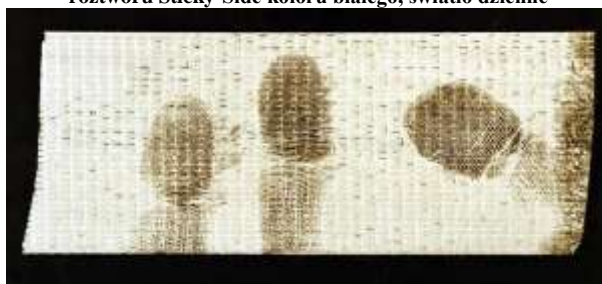
Fot. nr 17. Fragment wzmocnionej taśmy malarskiej z ujawnionymi śladami linii papilarnych po zastosowaniu roztworu Wet-Powder, światło dzienne
