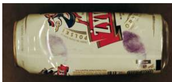
Fot. nr 17. Puszka po piwie „Żywiec” z ujawnionymi krwawymi śladami linii papilarnych, po zastosowaniu roztworu fioletu leukokrystalicznego (LCV), światło dzienne
