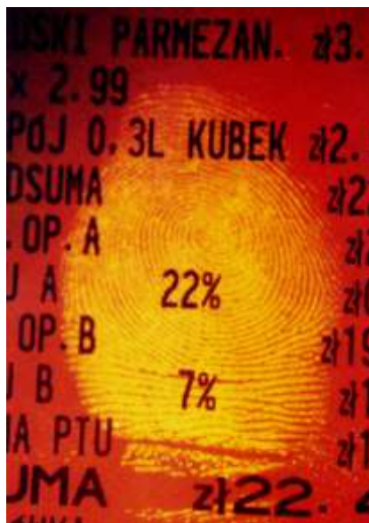
Fot. nr 15. Fragment paragonu z kasy fiskalnej, z ujawnionym śladem linii papilarnych, po zastosowaniu roztworu DMAC, światło 505nm filtr pomarańczowy
